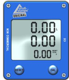
Drücken Sie die CAL-Taste für 5 Sekunden, um die abgegebenen Gesamtliter anzuzeigen. [LC] (Total L)
